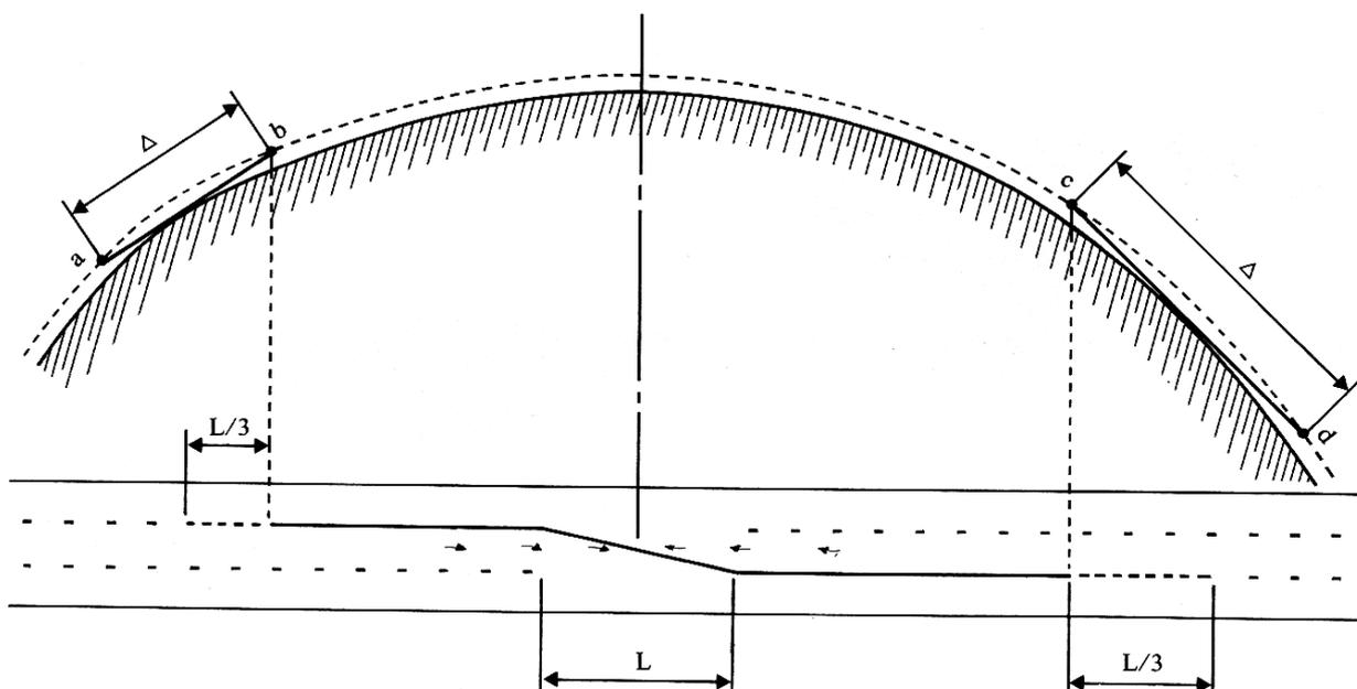
Lorsque la zone sans visibilité est de faible longueur, deux voies sont affectées, sur le point singulier considéré, préférentiellement à un sens de circulation. Qu'il y ait ou non recouvrement des zones de visibilité au sommet du dos-d'âne, le rabattement doit être effectué au point a ou au point d suivant le sens préférentiel qui a été retenu.
