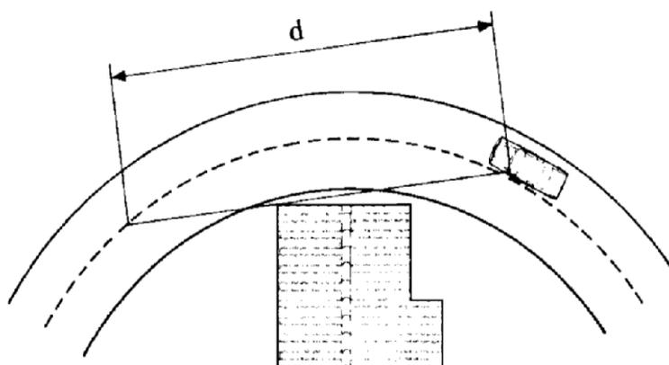
Les règles prévues à l'article R. 412-18 et R. 412-20 du code de la route conduisent à établir, au moyen d'une combinaison de lignes continues et discontinues, des zones de dépassement interdit aux points singuliers où la distance de visibilité est inférieure à un certain minimum  $\Delta$ .
