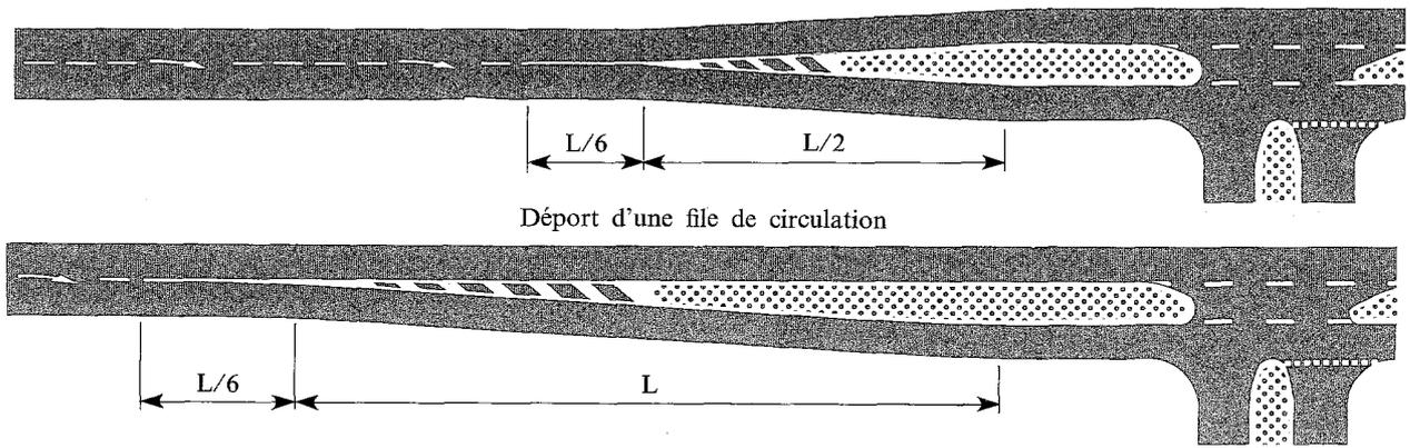
Par contre, lorsque l'implantation des têtes d'îlots est dissymétrique et correspond à un déport effectif d'une file de circulation, la longueur de la ligne oblique est égale à  $L$ .
